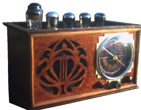
Eigenbau des Autors, 3- Kreis- Geradeausempfänger
